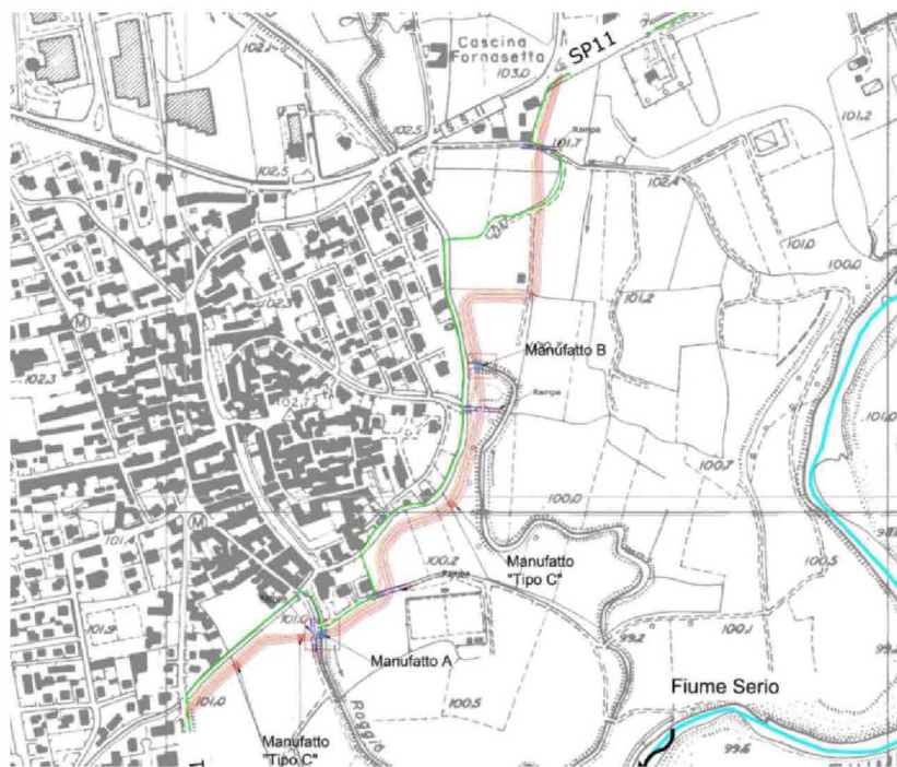
A sinistra, in rosso il tracciato dell'argine di protezione idraulica dell'abitato a sud-est di Mozzanica; sopra, una sezione del progetto
